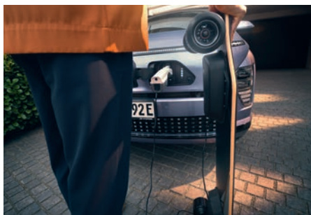
Port exterior V2L
