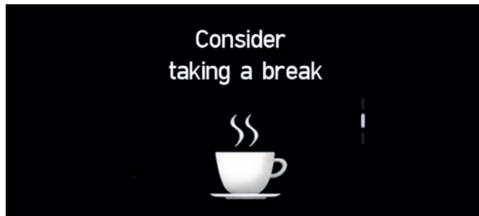
Sistem de atenționare a conducătorului auto (DAW).
