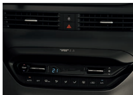
Instalație automată de climatizare.
