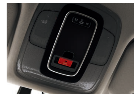
Sistem eCall - apeluri de urgență.
