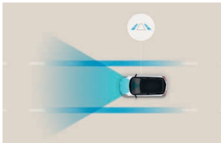
Sistem de asistență pentru menținerea autovehiculului pe centrul benzii de rulare (LFA).
