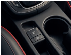
Frână electrică de staționare.
