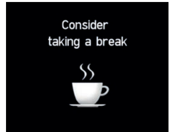
Sistem de atenționare a conducătorului auto (DAW).
