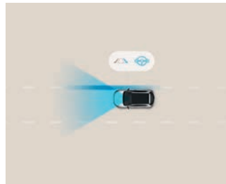
Sistem de asistență la păstrarea benzii de rulare (LKA).
