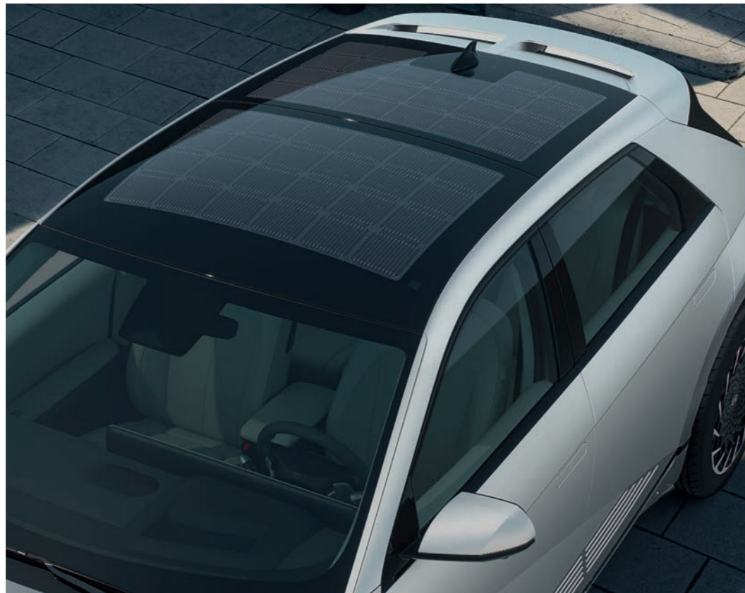
Plafon solar cu celule fotovoltaice. IONIQ 5 poate fi echipat cu plafon solar care poate preveni descărcarea bateriei, oferind în același timp o autonomie suplimentară.
