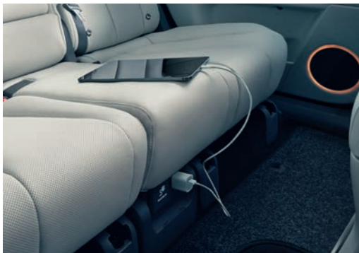
Încărcare facilă. Portul V2L, amplasat sub scaunele din spate, poate fi activat atunci când mașina este pornită. Sistemul poate furniza o putere de până la 3,6 kW.
