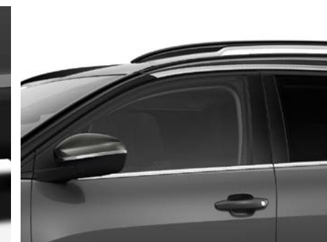
Inserții sub barele longitudinale plafon
