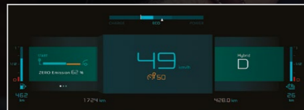
Modul Cadrane : permite vizualizarea informațiilor cu privire la modul de condus ELECTRIC/HYBRID/SPORT.
