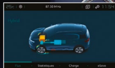
Flux de energie : permite vizualizarea modului de funcționare a tehnologiei hibride.
