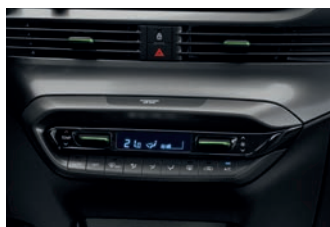
Instalație de climatizare automată.
